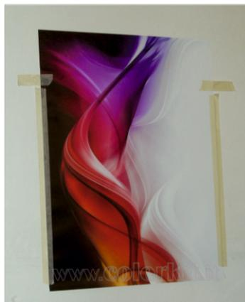
Posiziona la grafica e fissala lungo i bordi con del nastro adesivo da carrozziere, lasciando liberi i primi 10/20 cm. in alto
